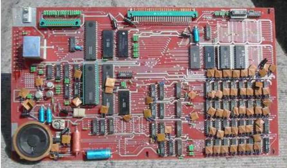
Základní deska – Mainboard IQ 151 se 64 Kb RAM, ZPA Nový Bor
